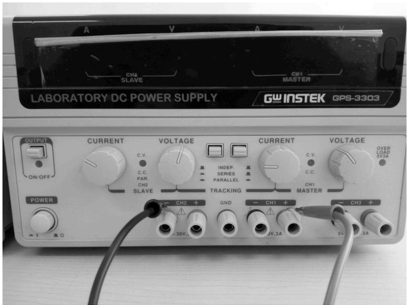
Figura 4.5 Ejemplo de conexión en serie para la fuente GW GPS-3303.
