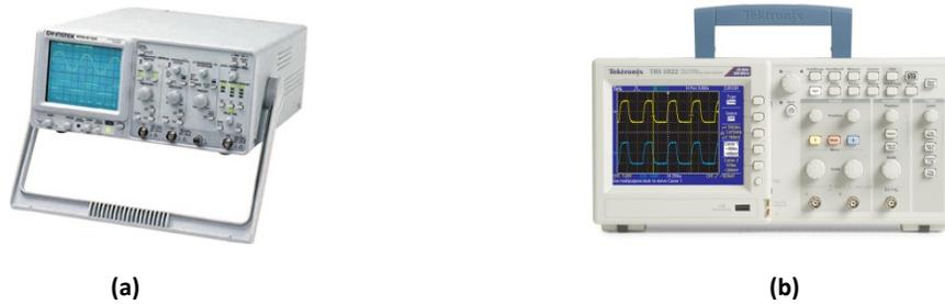
Figura 4.7. (a) Ejemplo de osciloscopio analógico. (b) Ejemplo de osciloscopio digital.
