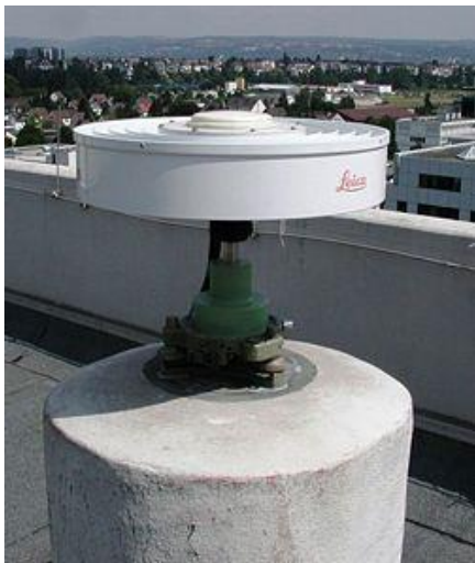
Figura 7. Estación de referencia del sistema de posicionamiento global (DGPS).
