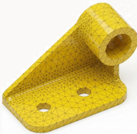
Mallado computacional de una pieza mecánica. Se muestra el mallado utilizado para analizar una pieza mecánica mediante simulación numérica. Cada triángulo representa una pequeña región en la que la computadora calcula esfuerzos, deformaciones y distribución de cargas. Este procedimiento permite predecir el comportamiento estructural de la pieza antes de fabricarla físicamente. (SolidWorks)
