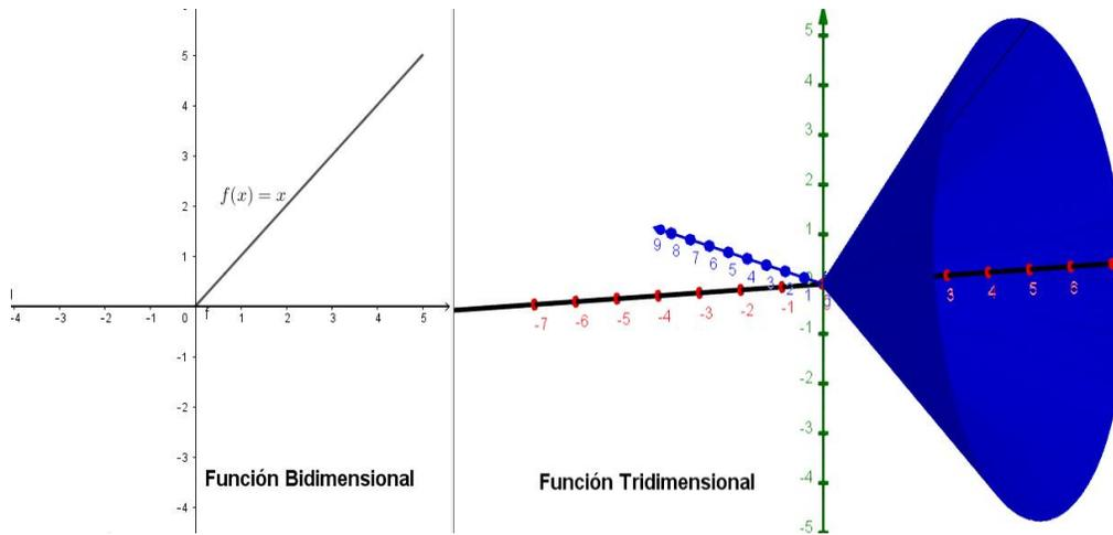
Imagen 14. Cambio de plano de una función algebraica, respecto al eje de las abscisas. Método de discos. Elaboración propia.
