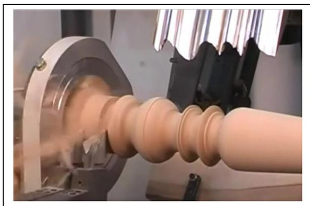
*Imagen 11. Elaboración de una figura tridimensional a partir de la rotación.*
