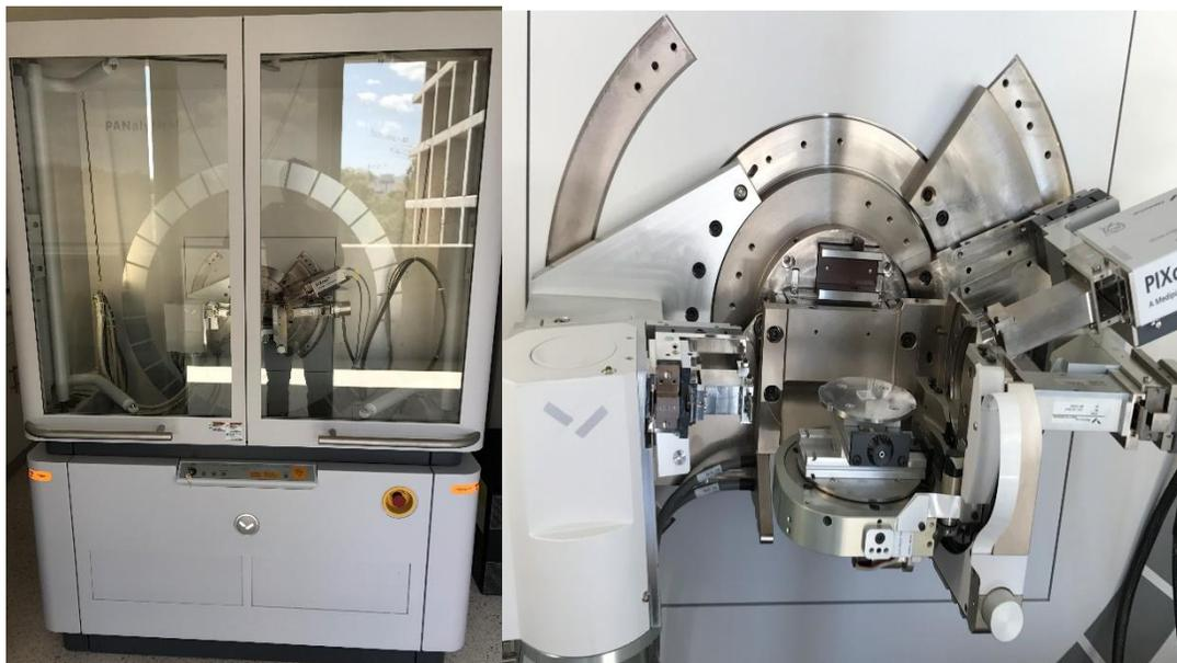
**Figura 3.6.** Difractómetro utilizado para la caracterización de las muestras.
