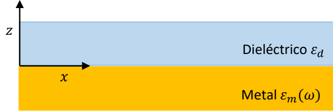
Figura 2.3 Geometría de la interfaz entre un dieléctrico y un metal, para propagar plasmones de superficie.
