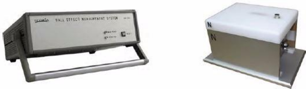
Figura 18(b). Instrumento Ecopia HMS-3000 para la medición de las propiedades eléctricas.
