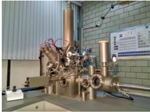
Figura 17. Equipo SIMS en el Laboratorio Avanzado de Nanoscopía Electrónica del Centro de Investigación y de Estudios Avanzados del IPN
