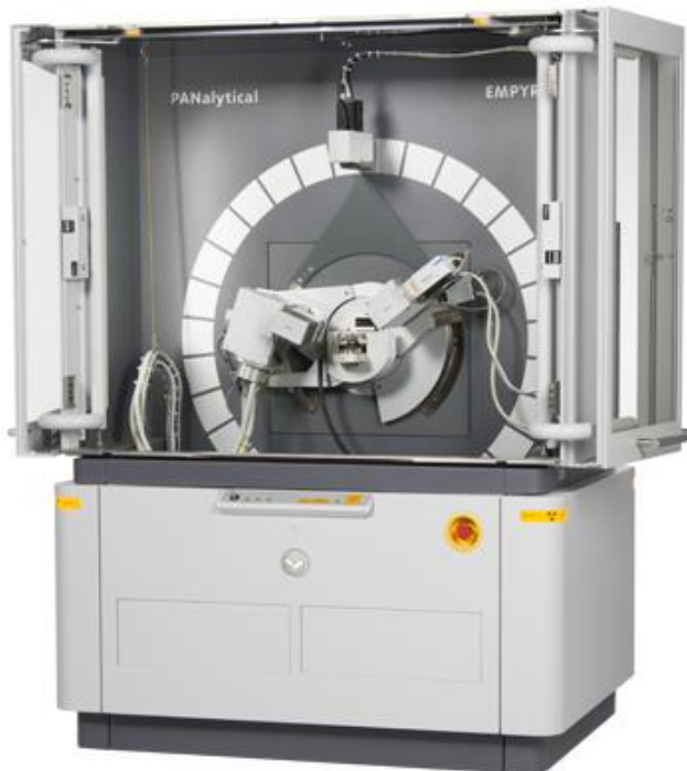
Figura 18. Instrumento Empyrean de difracción de rayos X (XRD)
